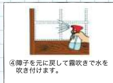
④障子を元に戻して霧吹きで水を吹き付けます。
